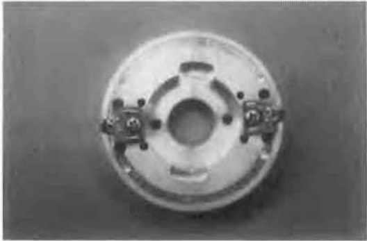
(d) Magnetic heads for VTR.
